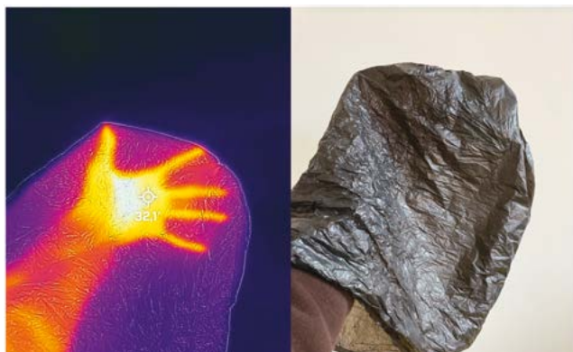
Rysunek 2.1. Powyżej. Zdjęcie dłoni zakrytej czarną folią w trybie MSX (podczerwień + kamera zakresu widzialnego, po lewej) i odbitym od nich świetle widzialnym (kamera zakresu widzialnego, po prawej). Na obrazie po lewej zaznaczony jest pomiar temperatury w centrum obrazu. Fotografie własne.
