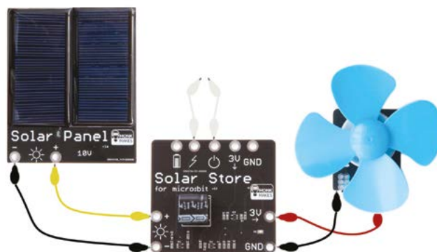
Rysunek 5.2. Panel fotowoltaiczny, magazyn energii i silnik z zestawu MonkMakes Solar Experimenter's Kit. Obrazek pochodzi z instrukcji producenta.
